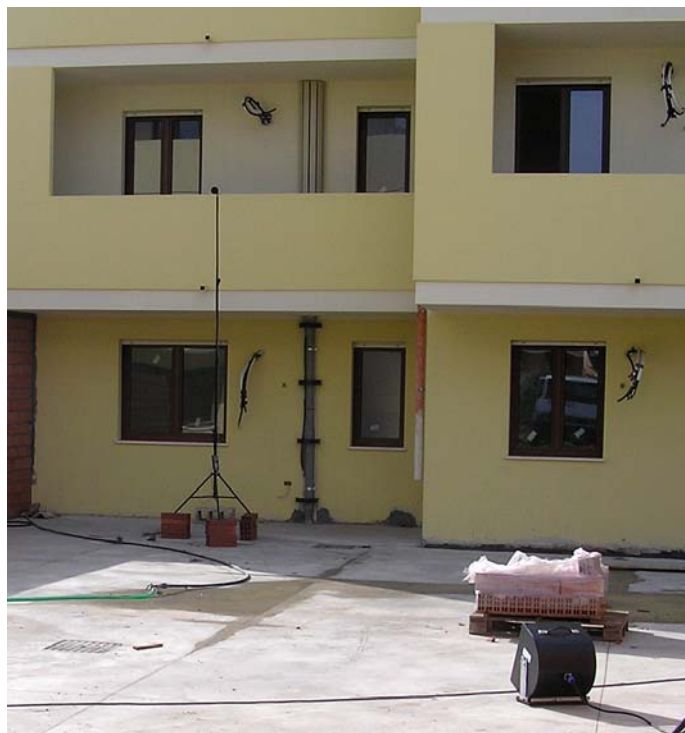
Prova di isolamento di facciata con sorgente direttiva e fonometro esterno.
