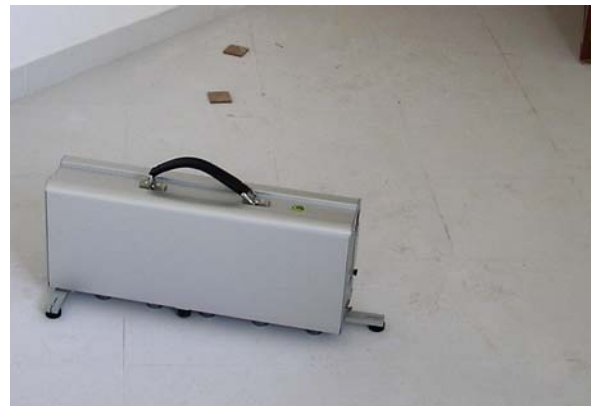
A sinistra: prova di isolamento tra ambienti con sistema multicanale capace di comparare contemporaneamente quattro misure. Qui sopra: macchina per il calpestio posata sul pavimento del primo piano.
