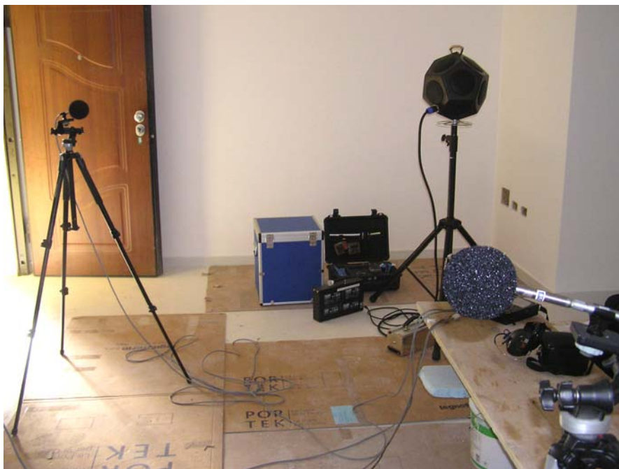
Verifica dei tempi di riverbero e isolamento tra ambienti con sorgente omnidirezionale.
