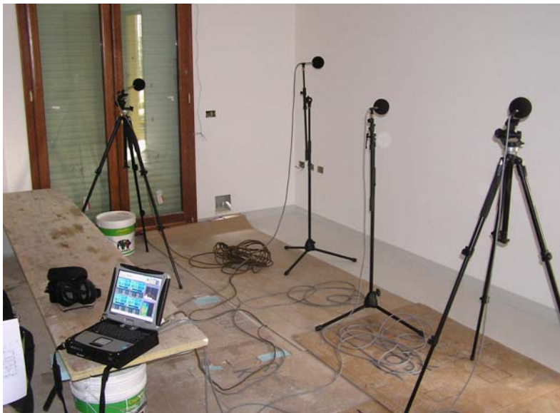
A sinistra: prova di isolamento tra ambienti con sistema multicanale capace di comparare contemporaneamente quattro misure. Qui sopra: macchina per il calpestio posata sul pavimento del primo piano.
